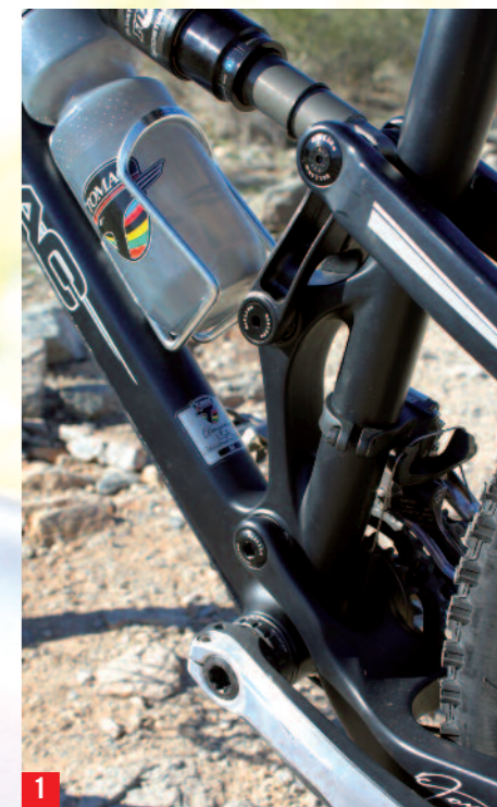
1. Vu sous cet angle, on pourrait croire à un triangle arrière unifié, pourtant il n'en est rien, nous sommes bien en présence d'un parallélogramme déformable.
